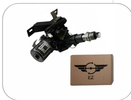
Si le câblage du klaxon et/ou du clignotant, par exemple, passe par l'arbre de direction, il doit être acheminé autour de l'unité EZ par l'intermédiaire d'un contact à ressort. Avec une tige de commutation le long de la colonne, nous utilisons une tige en forme de U pour contourner le moteur.
