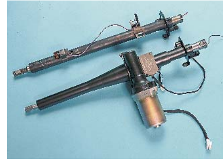
Haube auf: Im Motorraum des Jaguar wird nach dem Umbau kein Unterschied zu sehen sein. Alles Wesentliche spielt sich im Verborgenen ab – auch im Innenraum. Als erstes wird die originale Lenksäule demontiert, im Bild rechts liegt sie über dem schon fertig konfektionierten EZ-Umbausatz
