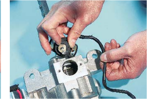
Dieser Sensor misst die Verwindung des Stabs und gibt sie als Elektroimpuls an die Blackbox
