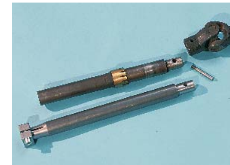
Alles geht – auch eine Lenksäule in gewünschter Länge, solange es der Platz im Auto zulässt
