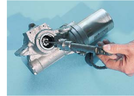
Im Lenkungsgehäuse läuft der Torsionsstab, der sich je nach Lenkkräften verwindet
