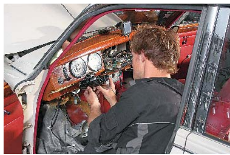
Die Verkabelung inklusive Lenkstockschalter ist fast noch der größte Montageaufwand
