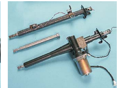
Original, Rohling und Neuteil: Die Jag-Säule ist problemlos unterzubringen – ein Glücksfall
