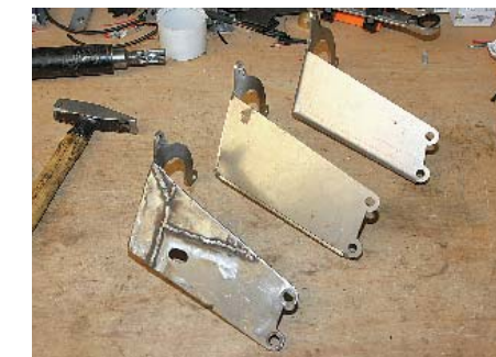
Unterschiedliche Entwicklungsstufen eines Lenksäulenhalters – das Endprodukt liegt oben
