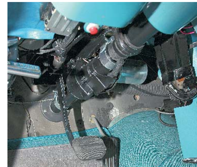
In der Chevrolet Corvette C1 wirkt die Servolenkung fast verloren. Je nach Gusto kann man sie stufenlos von leichtgängig bis straff regulieren
