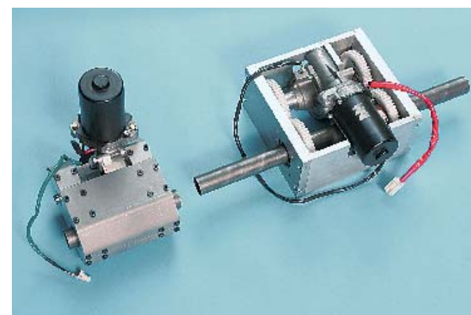
Die nächste Evolutionsstufe: Der Elektromotor treibt zwei Zahnräder an. Rechts liegt das Funktionsmodell, links der fast fertige Prototyp
