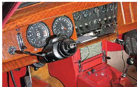
Sitzt, passt und hat keine (!) Luft: Elektrik und Servolenkung sind nun bestens verborgen
