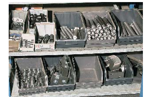
Die geteilten Säulen entstehen aus Vollmaterial – die Rohlinge passen bei fast allen Fahrzeugen
