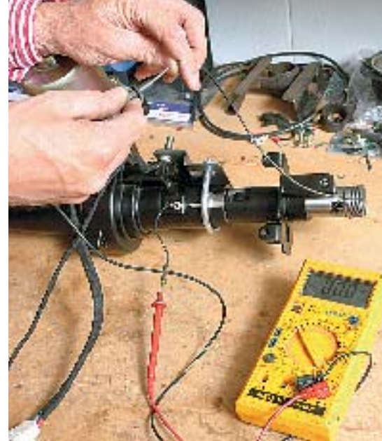
Die Kleinigkeiten sind die Herausforderungen: Der Hupkontakt wird per Schleifring hergestellt
