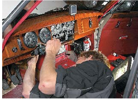
Haube auf: Im Motorraum des Jaguar wird nach dem Umbau kein Unterschied zu sehen sein. Alles Wesentliche spielt sich im Verborgenen ab – auch im Innenraum. Als erstes wird die originale Lenksäule demontiert, im Bild rechts liegt sie über dem schon fertig konfektionierten EZ-Umbausatz
