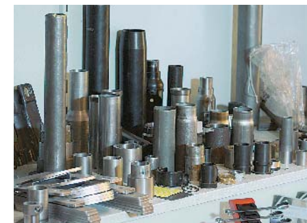
Müssen originale Lenksäulen angepasst werden, stehen genug Aufschweißhülsen zur Verfügung
