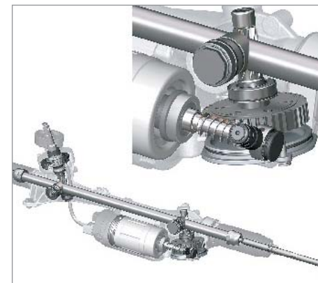
Die „Servoelectric“ wirkt nicht auf die Lenksäule, sondern ersetzt die liegende Zahnstange
