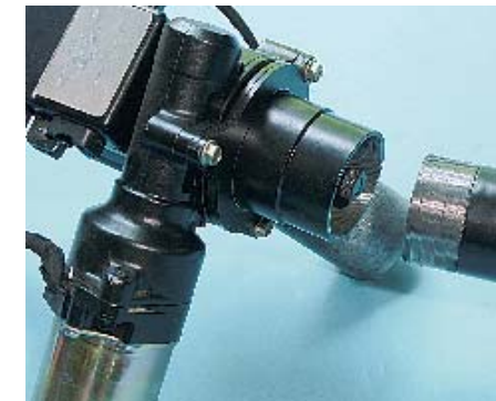
Das angepasste, originale Lenkmantelrohr des Jaguar MK II wird in diesem Fall geschraubt
