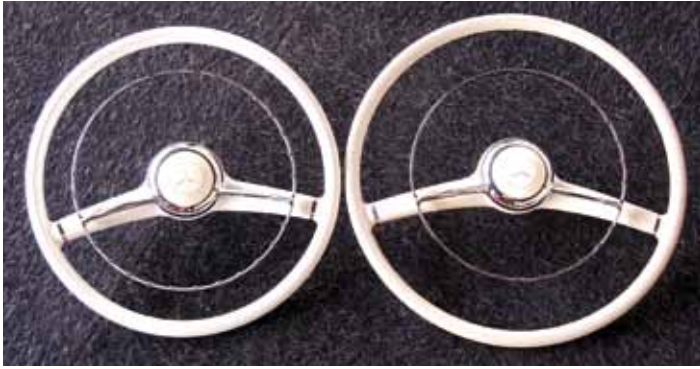
Stuurwielen van een 190 SL, nieuw (l) en oud; let op de afstanden tussen de rand en de chromen clignoteuring
