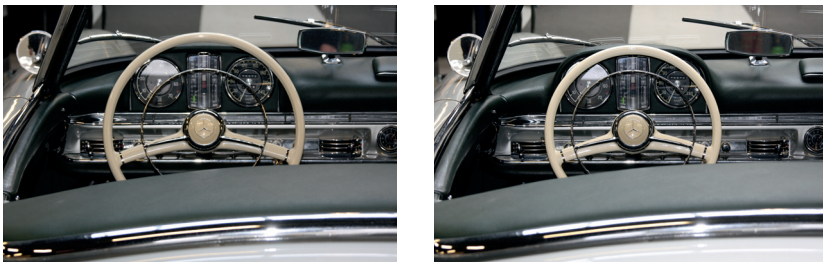
Kleiner stuur in een 300 SL. Het zicht op de instrumenten blijft gewaarborgd, ook voor lange bestuurders.
