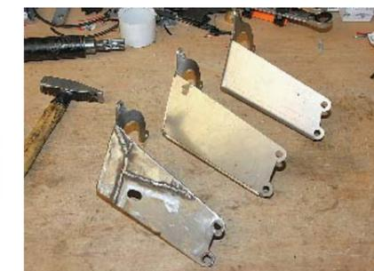
Unterschiedliche Entwicklungsstufen eines Lenksäulenhalters – das Endprodukt liegt oben
