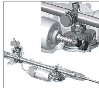
Die „Servoelectric“ wirkt nicht auf die Lenksäule, sondern ersetzt die liegende Zahnstange
