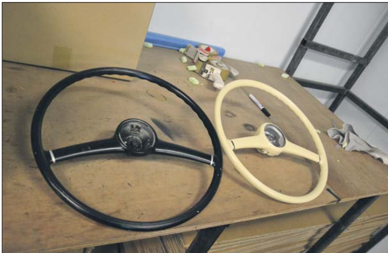
Twee Mercedes-sturen: links het originele stuur en rechts het nieuwe, dat net iets kleiner is.
