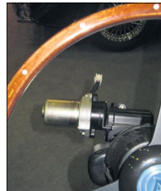
Servomotoren kommer til at sidde godt gemt et stykke nede på ratstammen.
